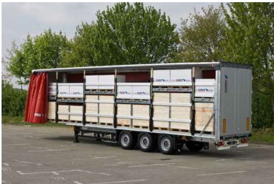
Obr. 6 Vícepodlažní vozidlo se stohovatelnou úpravou druhé podlahy
